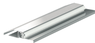
Práh z nerezové oceli k zárubním výroby Porta: ke dveřím ROMA a OPTIMAL standardní (90 mm), rozšířený (120 mm) k dvoukřídlovým dveřím: standardní (90 mm), rozšířený (120 mm)
